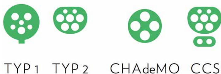
Figur 3. Illustration av de fyra vanligaste laddkontaktarna på en elbil. Bild hämtad från Emobility.se.
