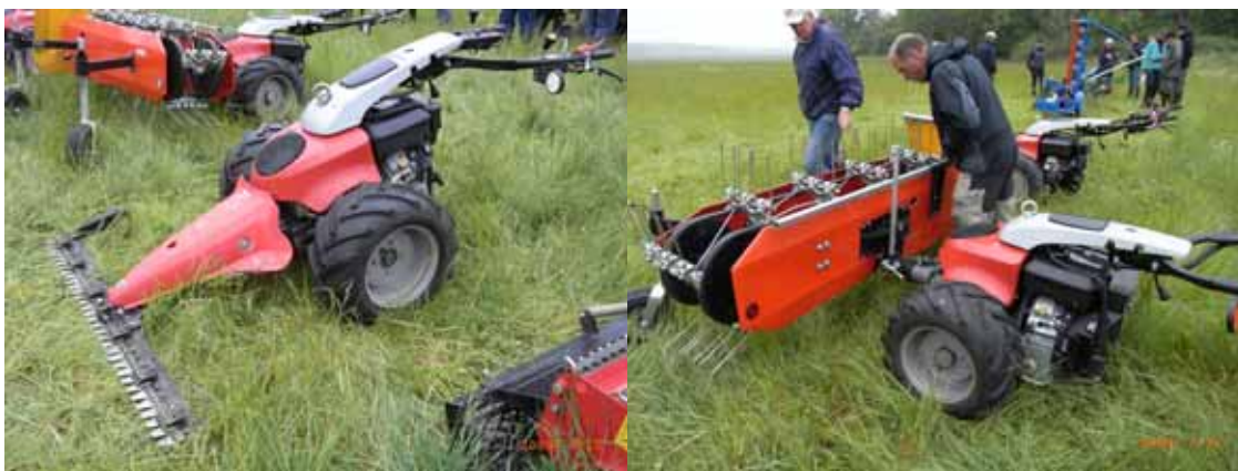
BILD 3. TVÅHJULSTRAKTOR (AEBI CC66) MED SLÅTTERBALK MONTERAD (VÄNSTER) OCH MED GAFFELSIDRÄFSA (HÖGER). (FOTO: MARVIN MARTINS)
