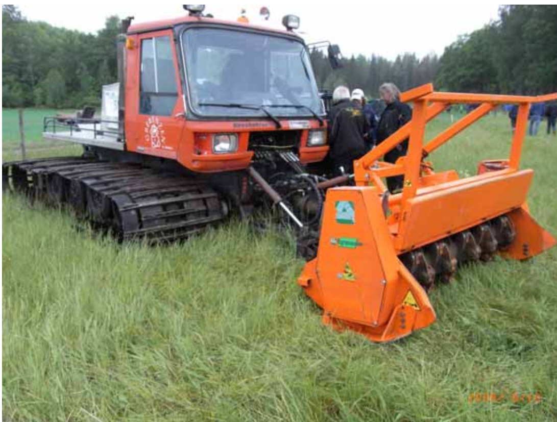
BILD 7. SLÅTTERMASKIN (PE-TE STUBBFRÄSNINGAR AB) MED FRÄSAGGREGAT MONTERAT. (FOTO: MARVIN MARTINS).
